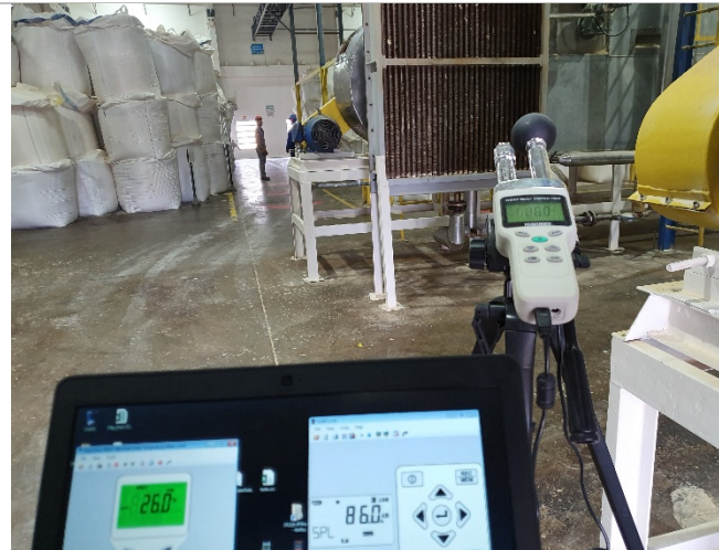
Foto 2 - Medição de Ruído e Calor.
