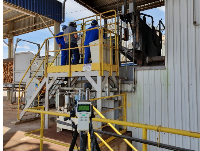
Foto 3 – Medição de Ruído e Calor.
