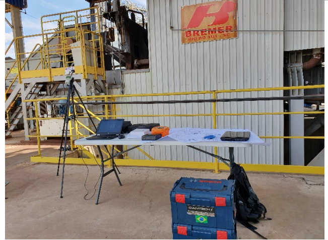
Foto 4- Medição de Ruído e Calor.
